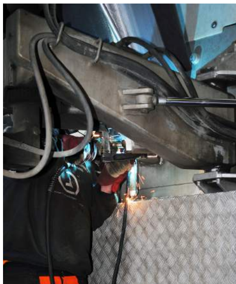
De anställda på Betongfrakt kan lite av varje. Här är det en trasig ränna som svetsas ihop.
