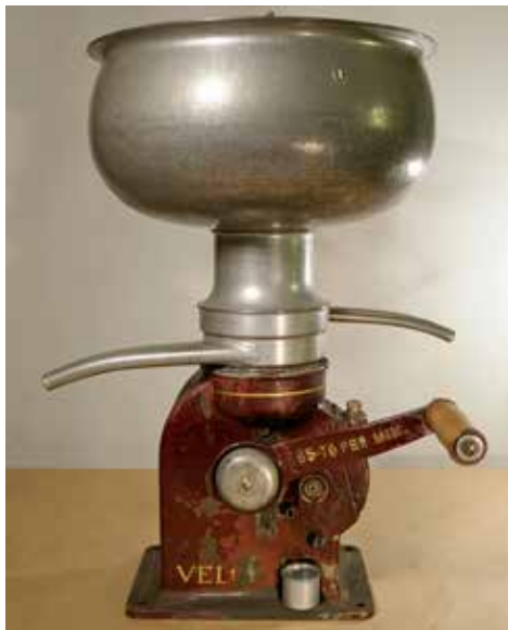
Det inbyggda plingande räkneverket hjälpte användaren att veva med rätt hastighet.
